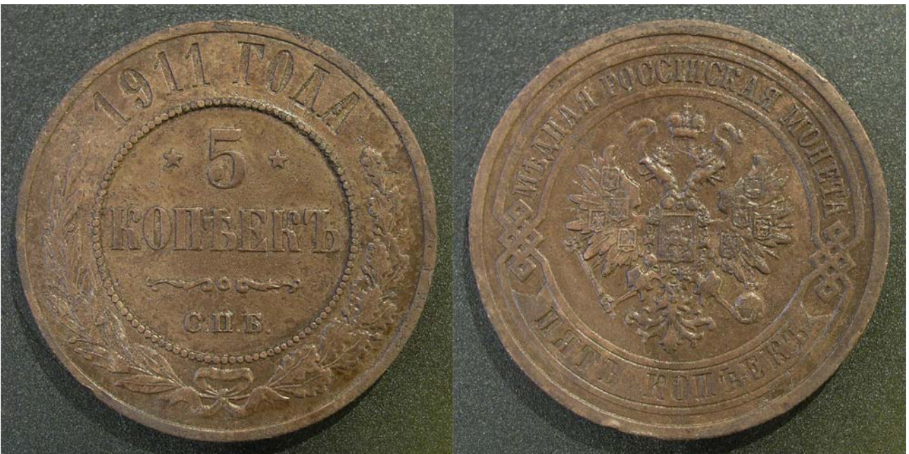
Монета из того же клада после чистки электролизом: видны каверны
